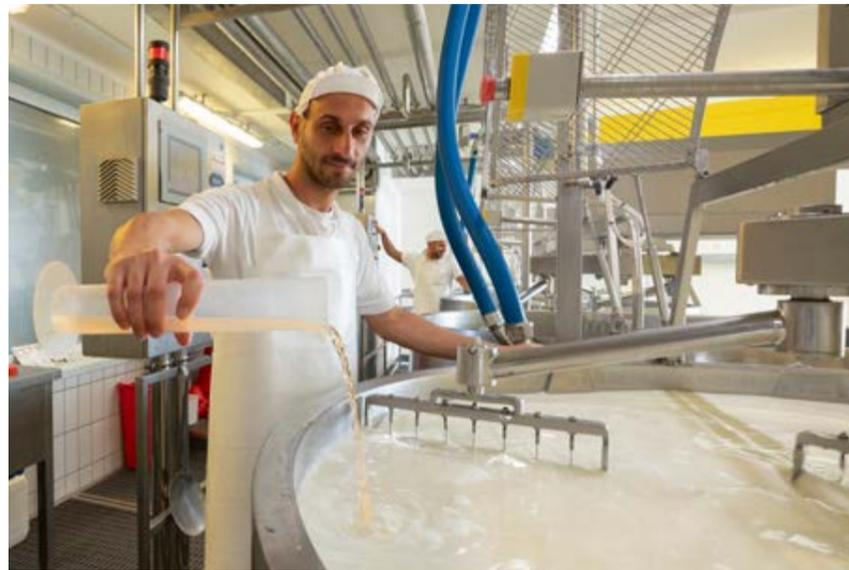
il latte viene portato alla temperatura adeguata per entrare nel vero e proprio processo produttivo.
